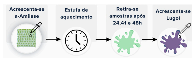
Figura 2. Representação esquemática do experimento da decomposição enzimática do biopolímero.
