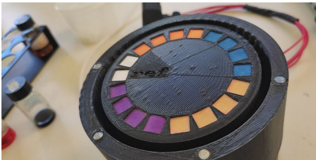
Figura 4. Arranjo de sensores colorimétricos (ASC) com corantes B20, B6, B7, B8, B22 e B23 sobre papel.
