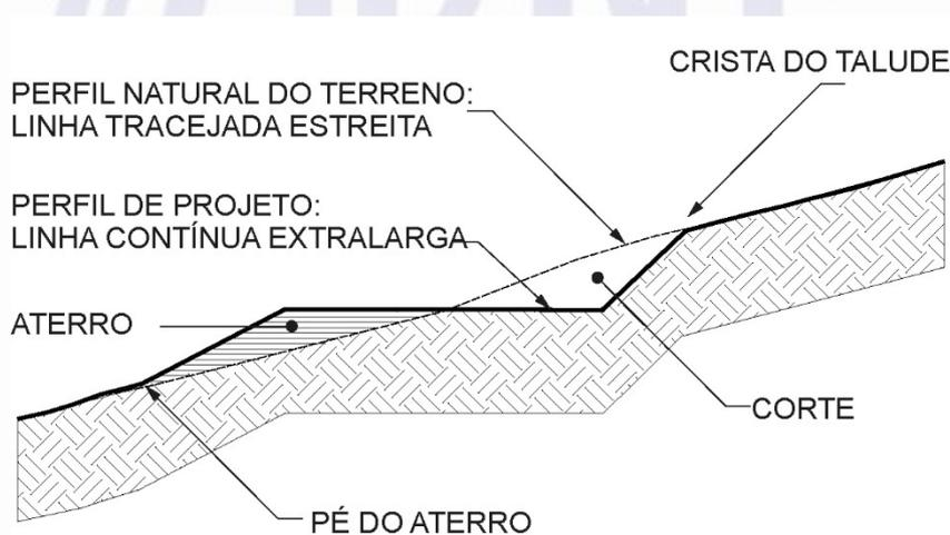
Figura A.6 – Exemplo de uso de linha – Seção esquemática
