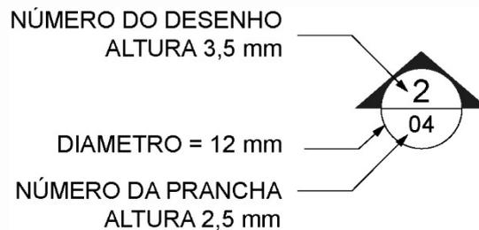
**Figura A.18 – Representação da indicação das fachadas e elevações**
