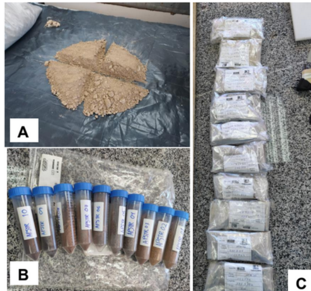
Figura 02: Pré-tratamento de amostras para análise química. A - Quarteamento; B – amostras para análise; C – Mostruário
