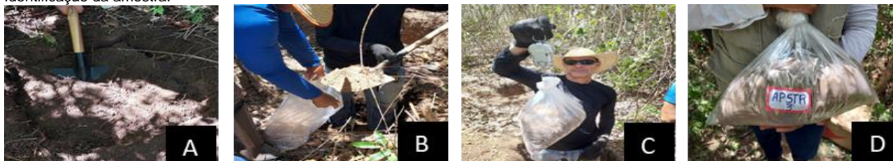
Figura 4. Coleta Indeformada. (A) Guia para o amostrador; (B) Retirada do solo no entorno do cilindro amostrador; (C) Retirada da amostra e (D) Amostra embalada.
