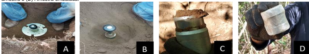
Figura 4. Coleta Indeformada. (A) Guia para o amostrador; (B) Retirada do solo no entorno do cilindro amostrador; (C) Retirada da amostra e (D) Amostra embalada.
