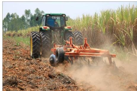
Figura 1: Maquinário realizando o revolvimento do solo<sup>7</sup>.
