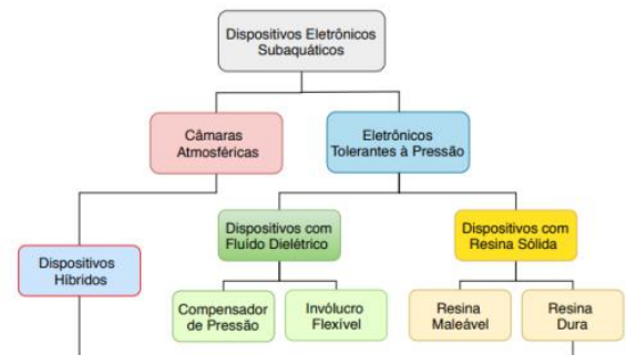
Figura 2: Soluções propostas para dispositivos eletrônicos subsea . Fonte: autoria própria.
