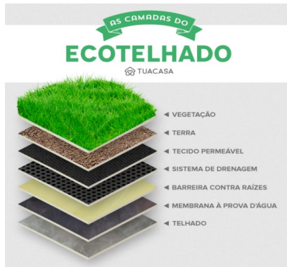
Figura 1 - Camadas do telhado verde.
