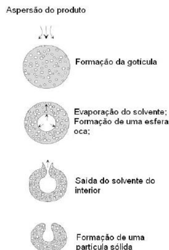
Figura 1. Processo formação de partícula seca através da secagem por aspersão. 3
