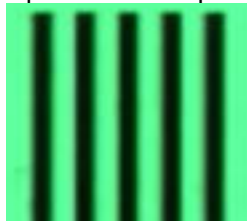
Figura 5: Padrões de linhas de um target com frequência de 10 lp/mm.
