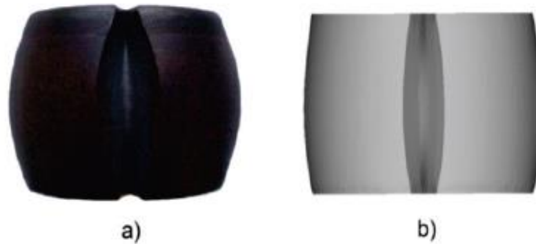
Figura 4: Distribuição de temperatura e tensão no corpo de prova a 700°C [8]
