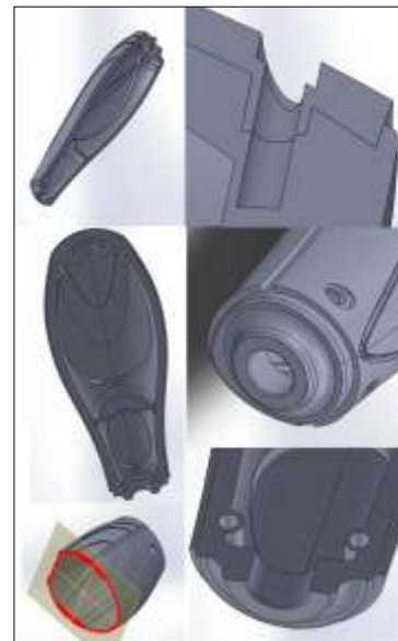
Figura 10: Cortes e detalhamento
